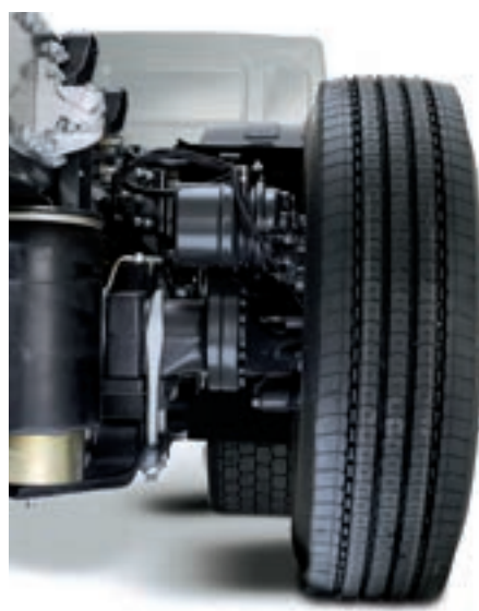
LUFTAFFJEDRING AF BAGAKSEL giver større stabilitet og bedre beskyttelse af fragten.
