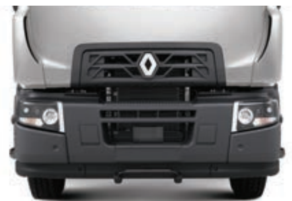
KOFANGER MED STÅLHJØRNER (C 2.3) for større hårdførhed.
